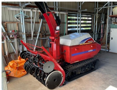
付属物品 除雪機 (ディーゼルエンジン型31馬力)
