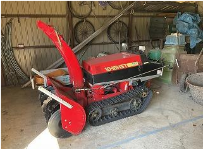
付属物品（中古除雪機1台、ガソリンエンジン16馬力、除雪幅1m）
